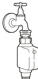
Заливной шланг с защитой от протечек
